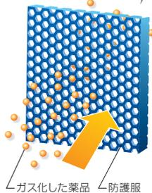
薬品がガス化して防護具を通過する現象を透過といいます。透過した薬品は皮膚から吸収されることがあります。ダイヤゴムT1-Nエプロンは透過を防ぎ、薬品が経皮吸収されるリスクを軽減します。
